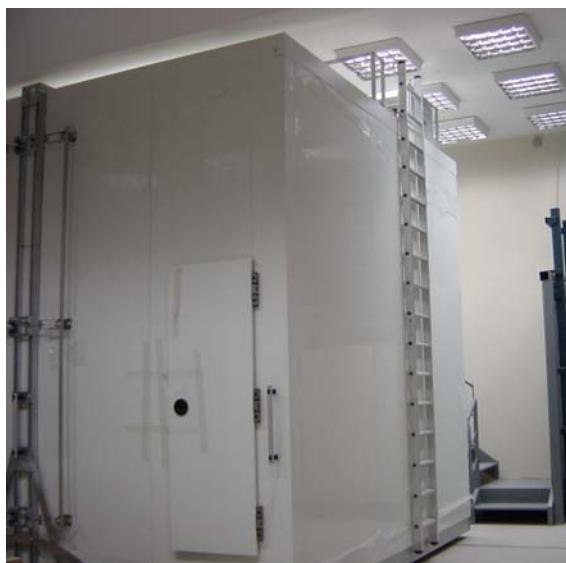
Φωτογραφία του συστήματος δοκιμών θερμομόνωσης.
