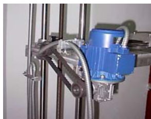
Σύστημα αυτόματης σάρωσης για μετρήσεις ηχητικής έντασης.
