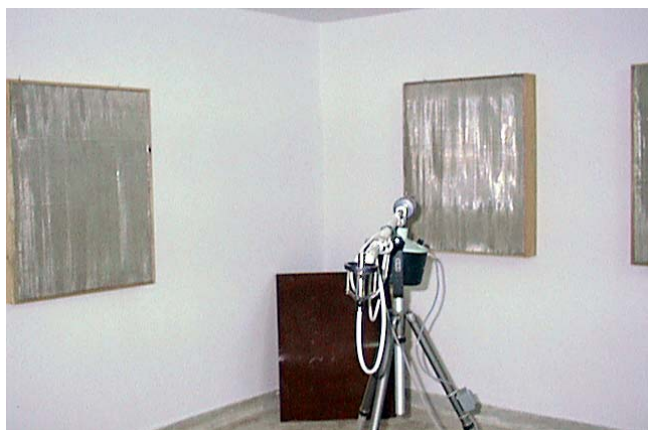
Φωτογραφία από το θάλαμο λήψης με τους ηχοαπορροφητές και ηχοδιαχυτές.
