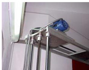
Σύστημα αυτόματης σάρωσης για μετρήσεις ηχητικής έντασης.
