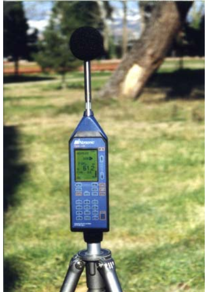
Φορητό ηχόμετρο μετρήσεων.
