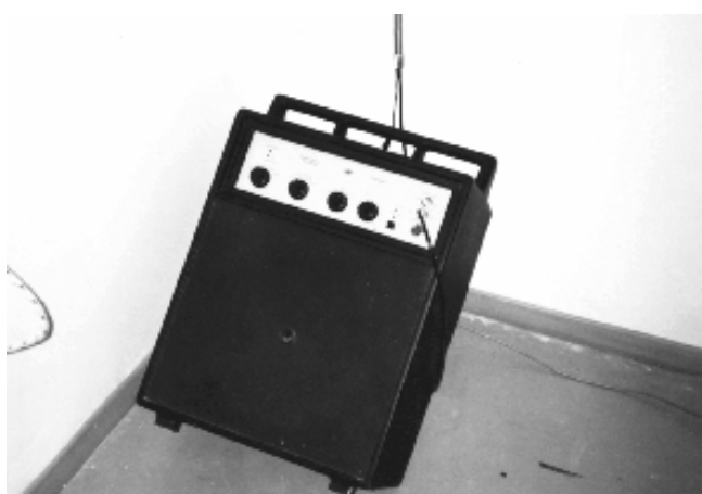
Η ηχητική πηγή του συστήματος μετρήσεων του Εργαστηρίου Αρχιτεκτονικής Τεχνολογίας.
